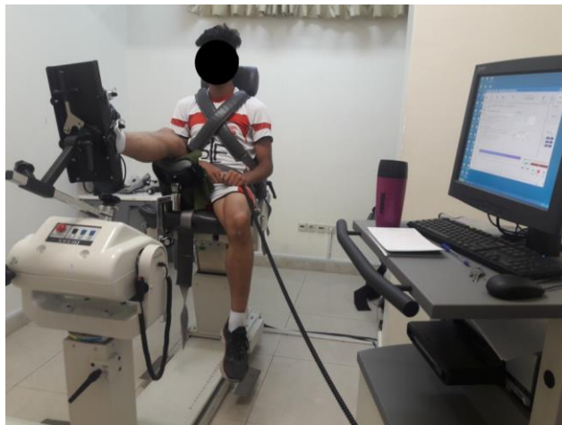
شکل ۳. اندازه‌گیری قدرت آیزوکنتیک و آیزومتریک اینورتورها و اورتورهای مچ پا
